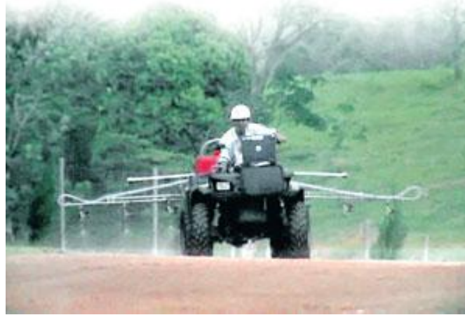
Rajah 3: Sistem penyembur racun automatik menggunakan jentera ATV
