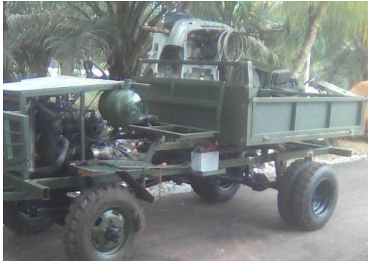
Rajah 4: Kenderaan pacuan empat roda yang digunakan bagi membawa tangki dan pam
