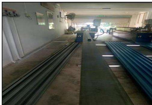
Rajah 2: Mesin Rolled Forming yang menghasilkan kerangka bumbung ringan
